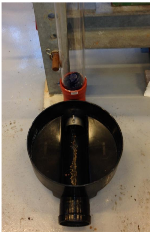
Foto 3. Prøvning af fastholdelse af rottespærre.
