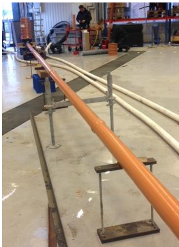
Foto 4. Forsøgsopstilling for test af enkelttab.
